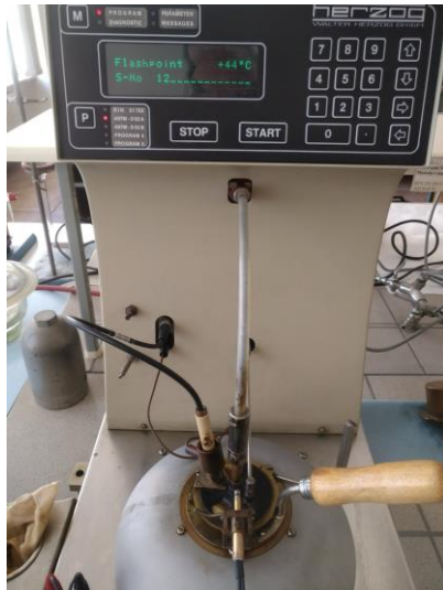
Obrázok 7. Testovanie bodu vzplanutia. Zdroj: [1].
