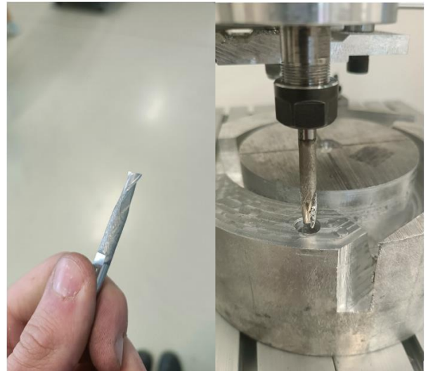
Obrázok 6. Úprava nástroja a ukážka "lepenia" hliníku na nástroj
