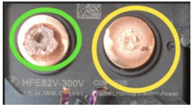
Obr. 4. Porovnanie zvarových spojov
