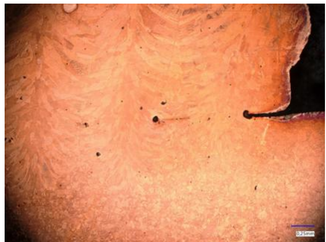
Obr. 5. Mikroštruktúra zvarového spoja - špirálový tvar
