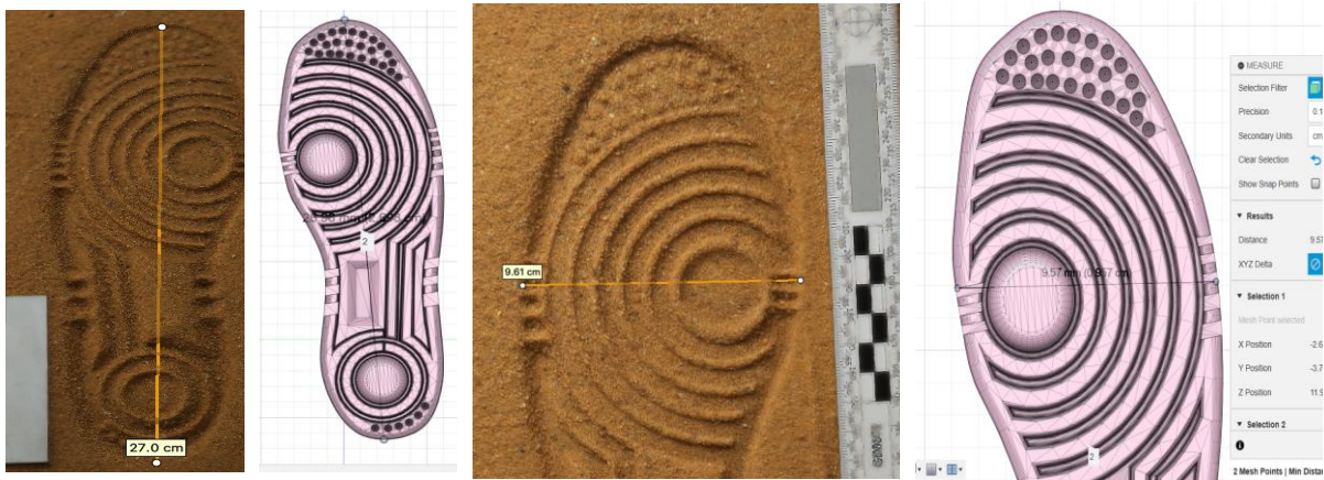
Obrázok 8 Komparácia dĺžky (vľavo) a šírky (vpravo) 3D modelu stopy s 3D substitučnou podrážkou (Kadnár, 2025)
