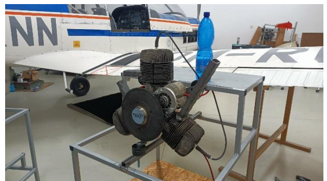
Obrázok 9. Zložený prototypový motor Traby
