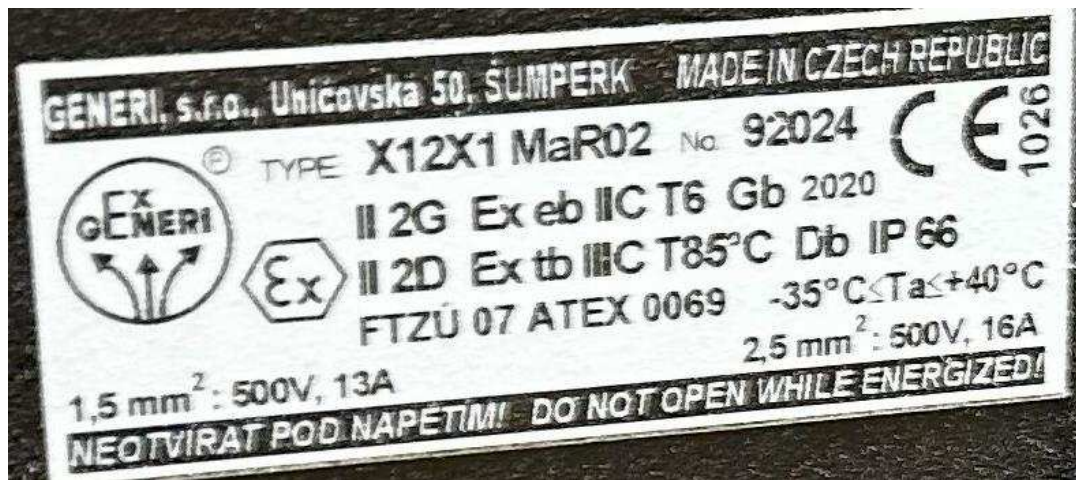
Obrázok 4 Výrobný štítok skrine bezpečnostných spínačov umiestneného vo výbušnej zóne na 4. nadzemnom podlaží technologického procesu v potravinárskom priemysle (podľa: Cabánik, 2023)
