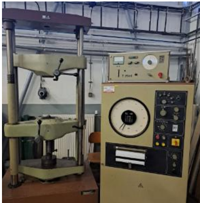
Obr. 5. Trhacie zariadenie EU 40 použité pre realizáciu Kudovej skúšky
