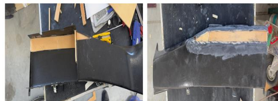
Obrázok 5 Vnútroňá výplň steny vstupného ústrojenstva a zabrušená stena pripravená na lamináciu a proces lepenia za pomoci epoxidovej živice
