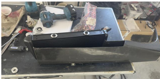
Obrázok 6 Odrezaný vonkajší kryt vstupného ústrojenstva
