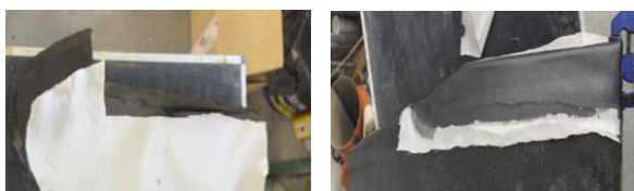
Obrázok 8 Vystrihnutá tkanina a nanosená na povrch s epoxidovou živicom
