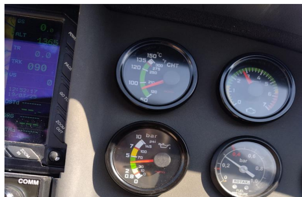
Obrázok 9 Teplota chladiacej kvapaliny po pristáti
