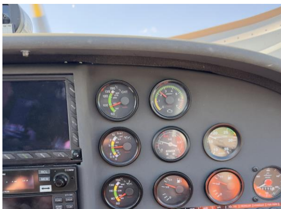
Obrázok 10 Teplota chladiacej kvapaliny po pristáti aerovleku
