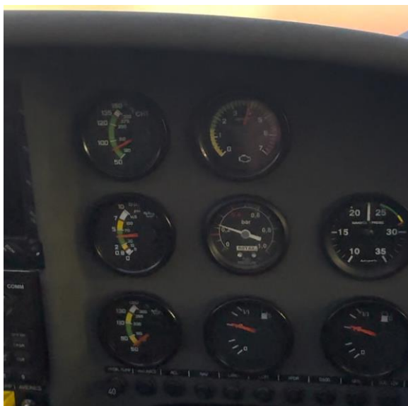
Obrázok 8 Prevádzkové teploty počas vykonania motorovej skúšky
