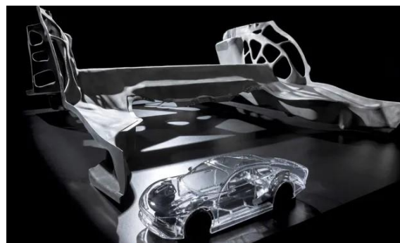
Obr. 3 Mercedes Benz s príkladom giga odliatku [3]
