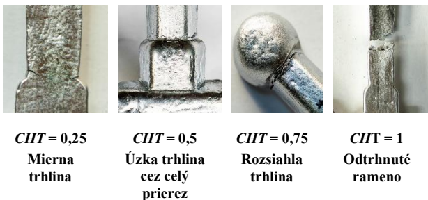
Obr. 2. Hodnotenie CHT na základe kategorizácie trhliny
