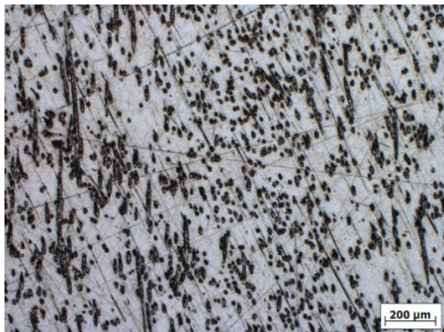
Obr. 2. Makroštruktúra povrchu materiálu pozdĺž vzorky kompozitu so sklenenými vláknami
