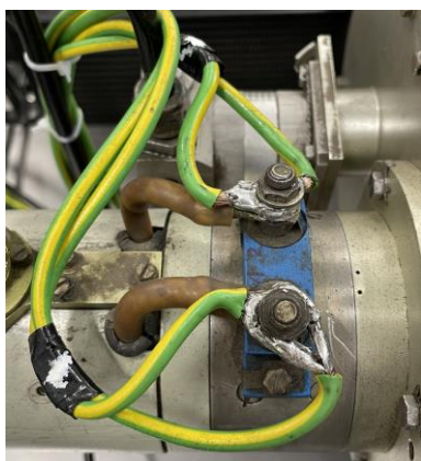
Obrázok 8 Privod elektrického prúdu do štartéra Zdroj: autor
