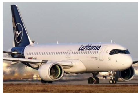
Obrázok 2: Airbus A320 NEO s pohonnými jednotkami Pratt & Whitney PW1100G [30]
