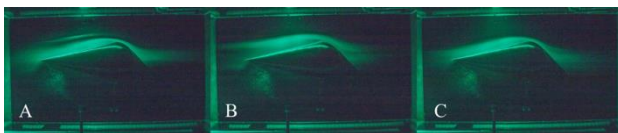
Obrázok 6. Obtekanie kvapky vo veternom tuneli pri rýchlosti (A) 35, (B) 45 a (C) 55 km/h
