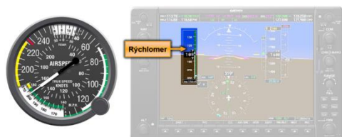
Obrázok 28: Vizualizácia informácií na analógovom a digitálnom rýchlomere [26] [27]
