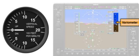
Obrázok 30: Vizualizácia informácií na analógovom a digitálnom variometre [26] [27]
