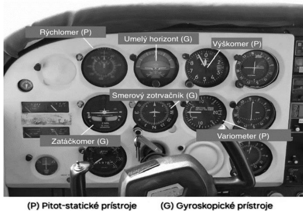
Obrázok 1. Typický súbor šiestich základných prístrojov "six-pack" v ľahkom lietadle. Zdroj: https://www.jetphotos.com/ (2005)
