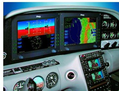
Obrázok 11: Prvý letún s digitálnym prístrojovým panelom Cirrus SR-22 [14]
