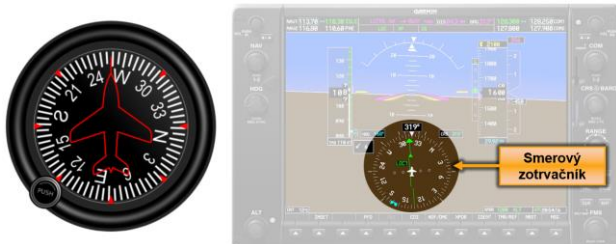
Obrázok 32: Vizualizácia informácií na analógovom a digitálnom smerovom zotrvačníku [26] [27]
