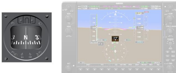
Obrázok 37: Vizualizácia informácií na analógovom a digitálnom magnetickom kompase [3] [27]
