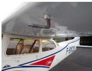
Obrázok 2: Pitot-statická trubica na letúne Cessna C172F Skyhawk [5]
