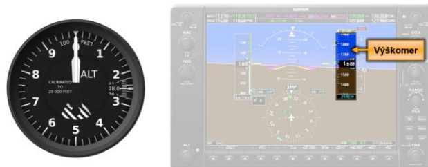
Obrázok 27: Vizualizácia informácií na analógovom a digitálnom výškomere [26] [27]
