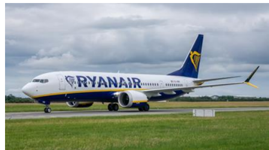
Obrázok 6: Boeing 737 MAX 8200 leteckej spoločnosti Ryanair s pohonnými jednotkami CFM Leap 1B a zakončením krídla typom "Advanced Technology Winglet" [34]
