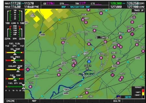
Obrázok 14: Navigačný displej (ND) Garmin G1000 [19]
