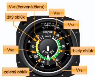
Obrázok 29: Štandardné farebné odlišovacie značky na rýchlomere [3]
