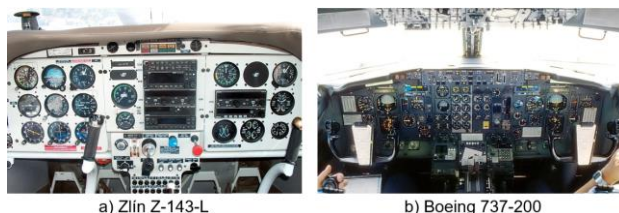
Obrázok 26: Rozloženie leteckých prístrojov podľa typu letúna [24] [25]
