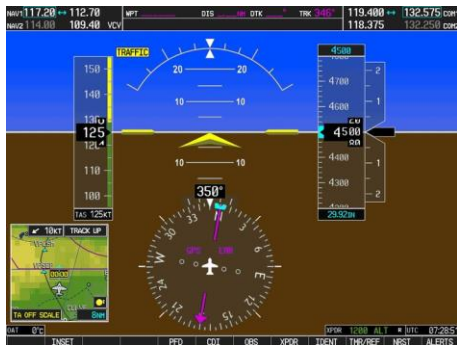
Obrázok 13: Primárny letový displej (PFD) Garmin G1000 [18]
