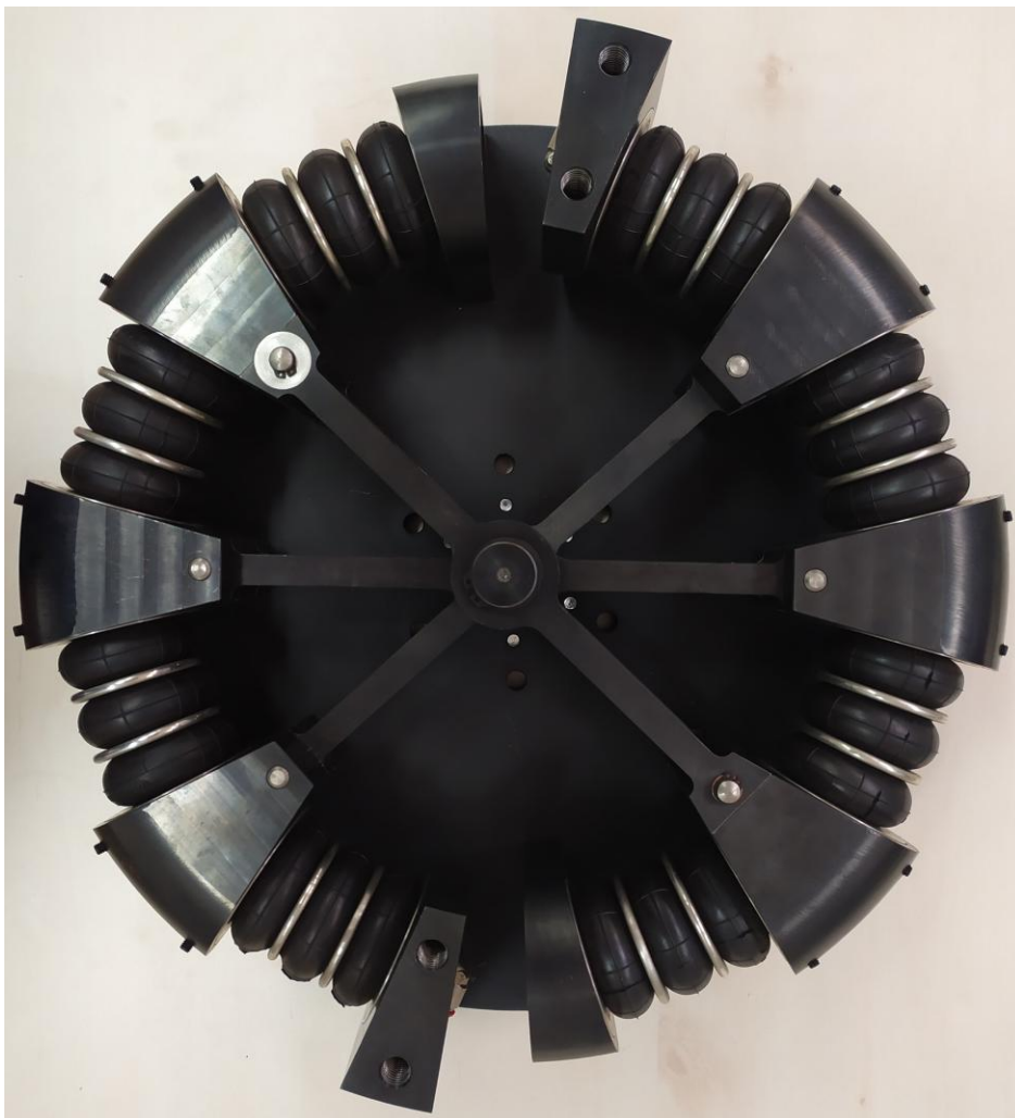
Obr. 6. Vnútorne usporiadanie pneumatickej pružnej reťazcovej hriadeľovej spojky
