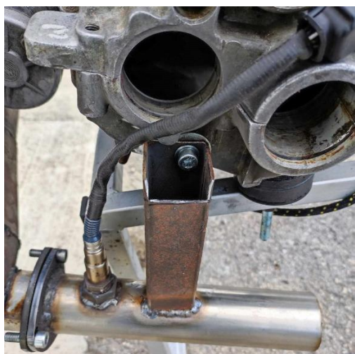
Obrázok 6 Snímač Lambda sonda. Zdroj: autor
