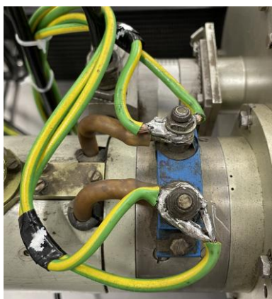
Obrázok 8 Privod elektrického prúdu do štartéra Zdroj: autor
