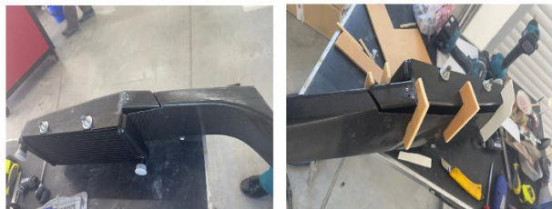
Obrázok 7 Vstupné ústrojenstvo spojené s chladičom a odrezanou spodnou časťou kde držiaky v tvare vytvárajú pomyselnú rovinu
