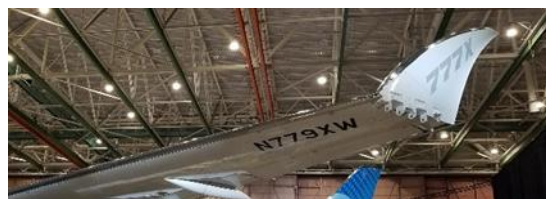
Obrázok 10 Sklopné zakončenie Boeingu 777X Zdroj: Dan Neville
