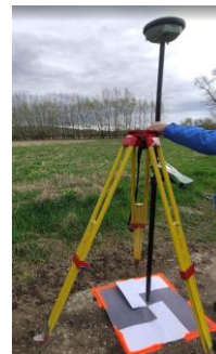
Obrázok 3 Zameranie polohy a označenie vlícovacieho bodu
