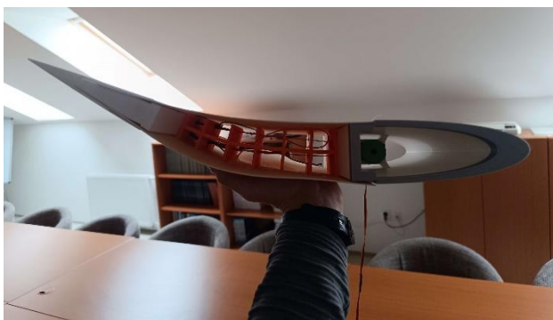
Obrázok 15: Model FishBAC dolné vychýlenie. Zdroj: autor
