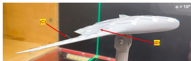
Obrázok 7 Veterný tunel pri \alpha = 10^\circ
