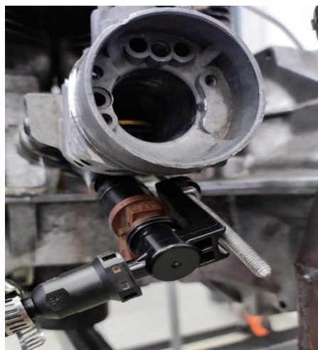
Obrázok 7 Škrtiaca klapka s palivovou dýzou. Zdroj: autor
