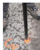
Obrázok 4 Zameranie bodov pre kalibráciu totálnej stanice
