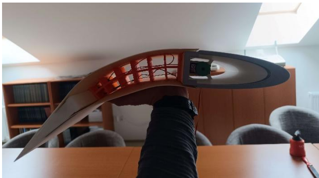
Obrázok 14: Model FishBAC horné vychýlenie. Zdroj: autor
