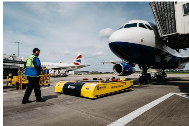
Obrázok 3: Diaľkovo ovládané výtlačné vozidlo Mototok, zdroj: (British Airways, 2017)
