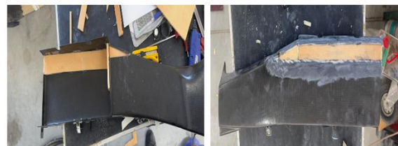
Obrázok 5 Vnútrná výplň steny vstupného ústrojenstva a zabrušená stena pripravená na lamináciu a proces lepenia za pomoci epoxidovej živice
