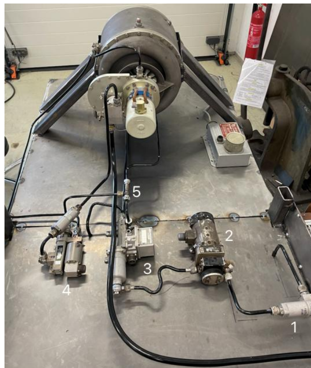
Obrázok 2 Zapojenie palivovej sústavy Zdroj: autor
