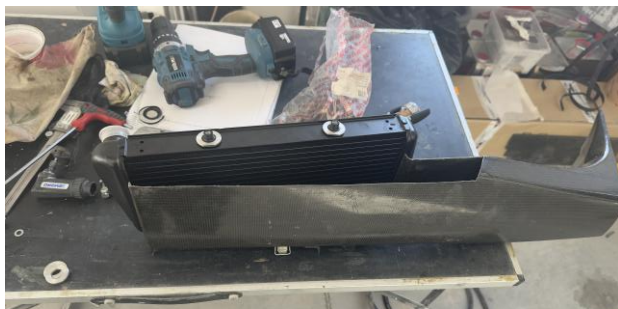
Obrázok 6 Odrezaný vonkajší kryt vstupného ústrojenstva
