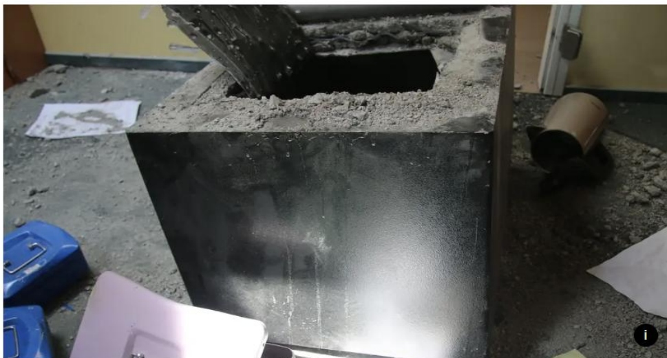
Obrázok 4 Pozostatok peňažného automatu po „Rip-out“ útoku (Figuli, 2025)
