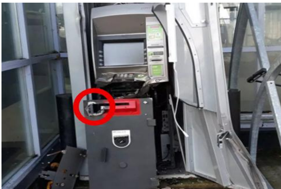
Obrázok 5 Pozostatok peňažného automatu po „Rip-out“ útoku (Doherty, 2017)
