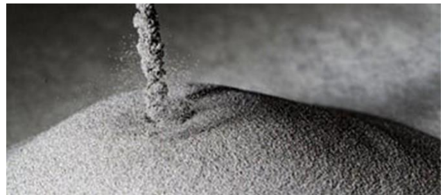
Obr. 4. Titánový prášok pre aditívnu výrobu [6]
