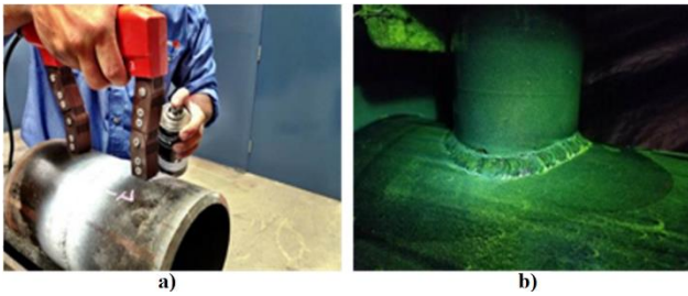
Obr. 2. Magnetická prášková metóda: a - farebná, b - fluorescenčná
