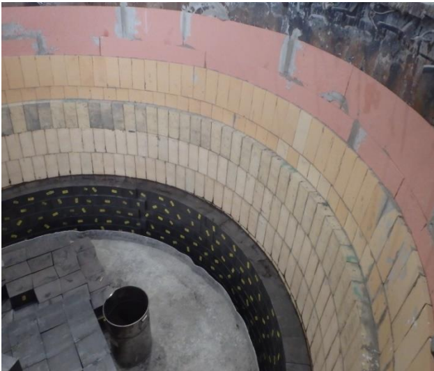
Obr. 1. Výmurovka liacej panvy v oblasti troskovej čiary
