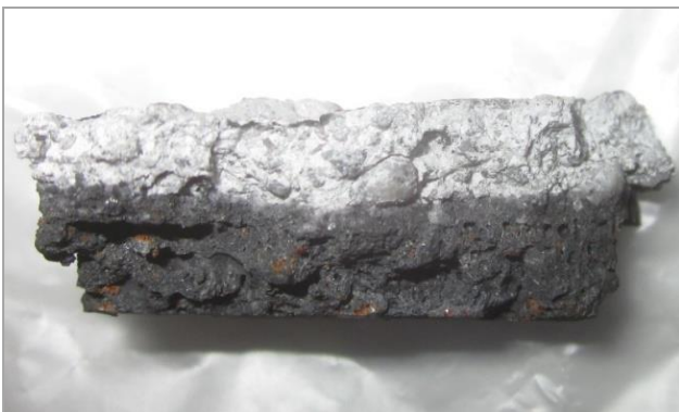
Obr. 5. Úlomok žiarobetónu „post mortem“ z LP č. 5
