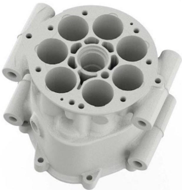
Obr. 6. Blok valcov zo zliatiny Inconel 625 vyrobený aditívnymi práškovými technológiami 9
