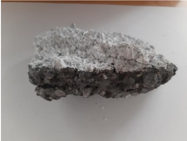
Obr. 8. Úlomok žiarobetónu „post mortem“ zo spracovacej panvy č. 2
