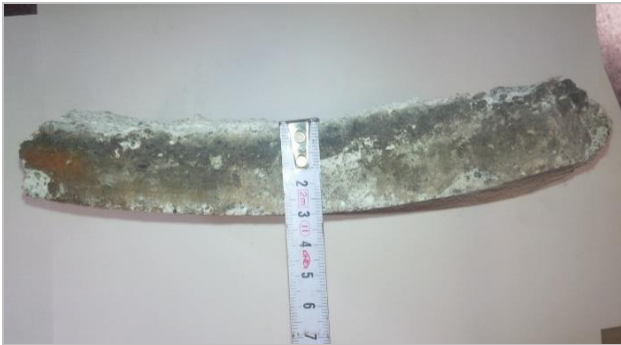
Obr. 4. Zostatková hrúbka výmurovky z Kofondu FAB 75
