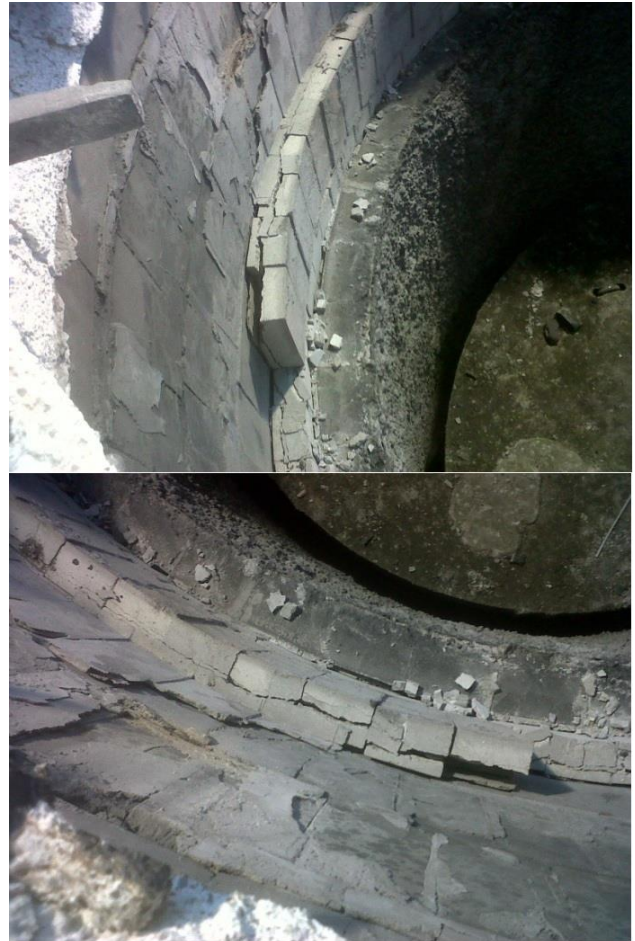
Obr. 4 Rozpadnutá trvalá výmurovka liacej panvy z kvality KOMAG KK po 350 liatiach
