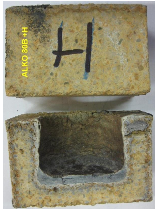
Obr. 5 Koróznny test troskou - ALKO 80 B
