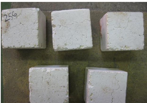
Obr. 9. Odolnosť proti náhlym zmenám teploty žiarobetónu Kosat SP 25 CM
