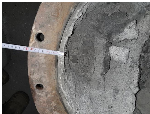
Obr. 7. Zostatková hrúbka výmurovky z Kosat SP 25 CM
