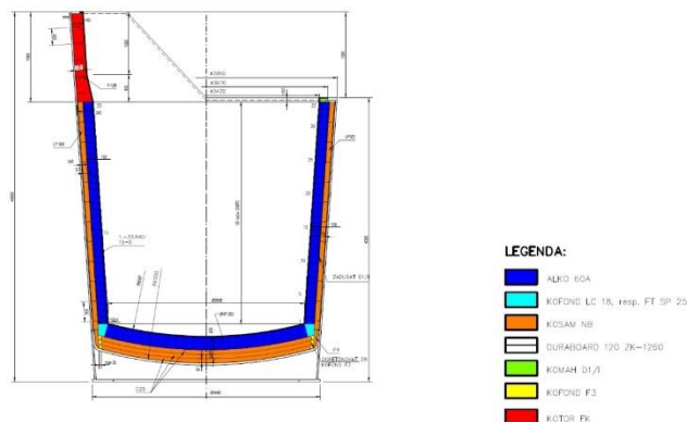
Obr. 14. Schéma výmurovky nalievacej panvy
