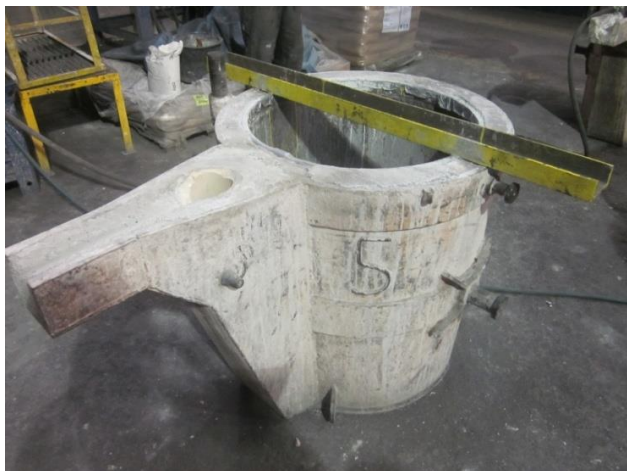
Obr. 1. Realizácia monolitckej výmurovky liacej panvy č. 5
