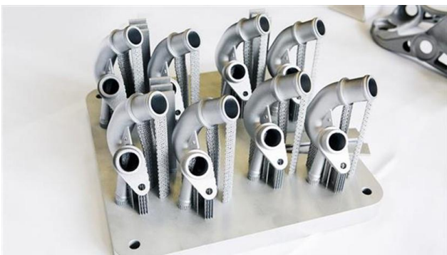
Obr. 3. Vodné konektory do motora AUDI W12 vyrábaných 3D tlačou z kovových práškov [5]
