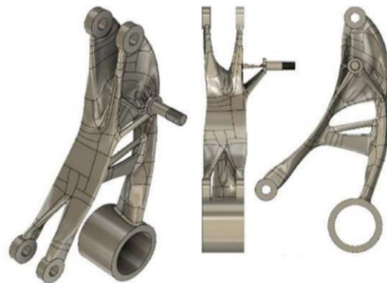
Obr. 3. Postup generatívneho dizajnu vahadla
