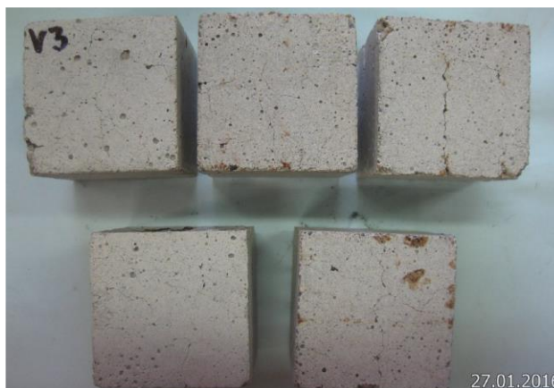
Obr. 3. Odolnosť proti náhlym zmenám teploty žiarobetonu Kofond FAB 75
