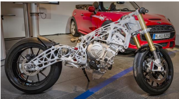
Obr. 2. Prototyp kovového rámu motocyklu vyrábaného aditívnymi technológiami, vystavený na podujatí BMW Digital Day [4]
