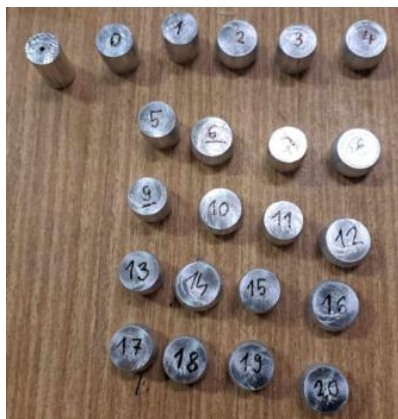
Obr. 6. Pripravené vzorky, očíslované od 1 po 20, so skúšobným valcom označeným bodkou slúžiacim na kalibráciu faktorov experimentu
