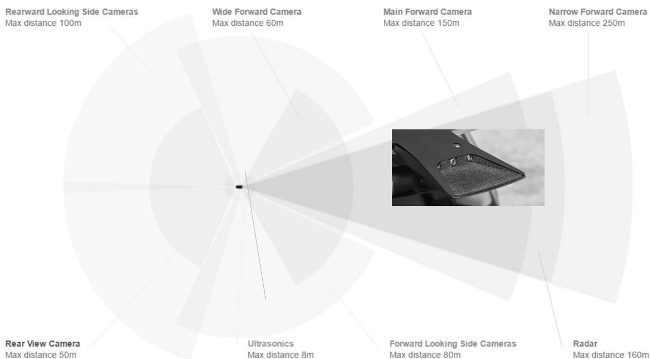
Obr. 27 Záber trojitej kamery Tesla a jej doplnkových senzorov [25]
