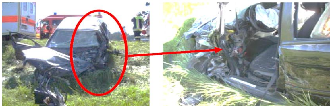
Obr. 64 Deformácia vozidla po náraze na pozdĺžny nosník [43]
