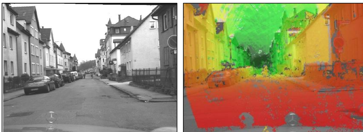
Obr. 19 Oblasť záberu kamery (vľavo). Farebné spektrum vzdialenosti objektov pred vozidlom (vpravo) [21]
