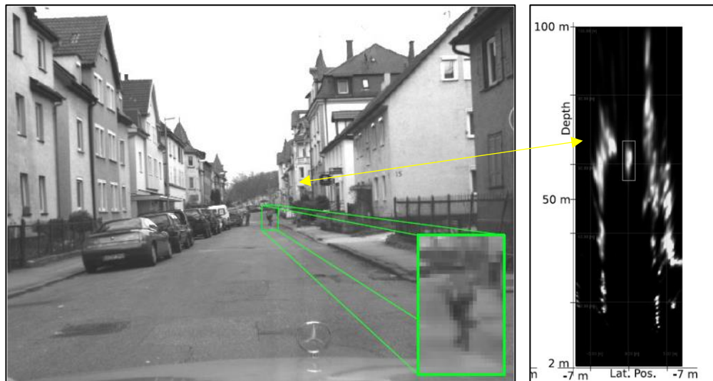
Obr. 20 Prevod obrazu do karteziánskeho súradnicového systému [21]
