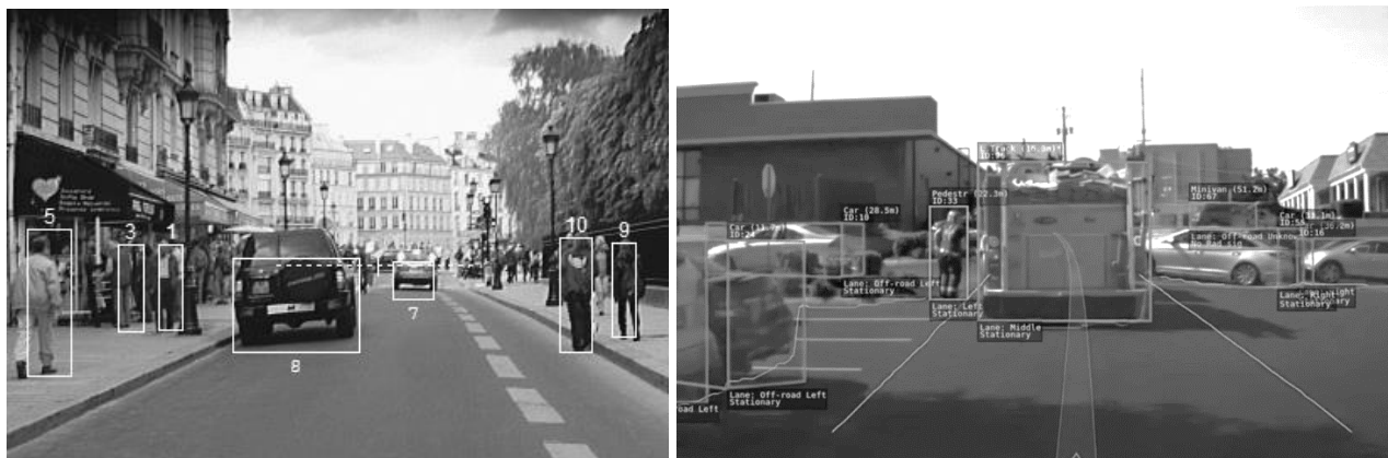
Obr. 16 Príklad rozpoznávania objektov z monokamery Volvo (vľavo), Tesla (vpravo) [17] [18]
