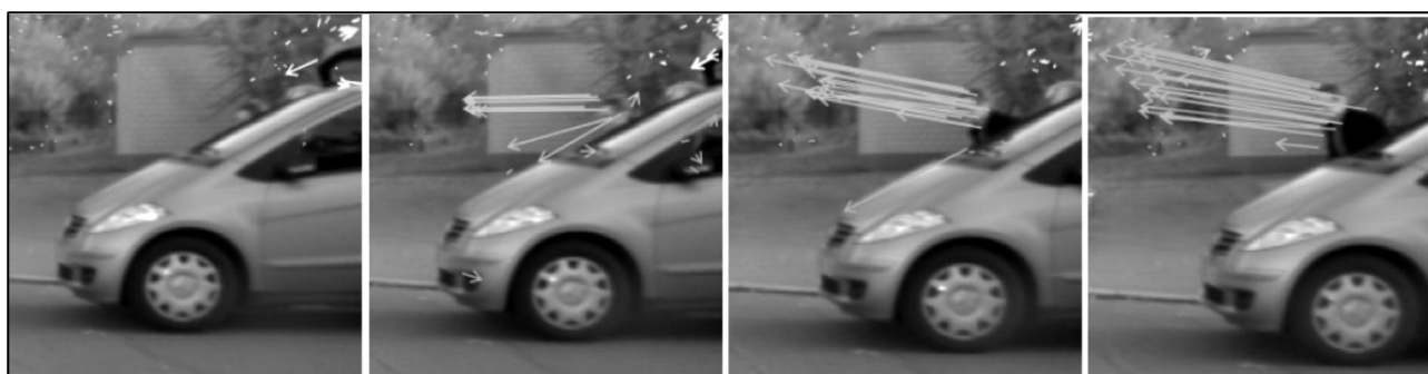
Obr. 22 Príklad trakovania pohybu chodca pomocou stereokamery [21]
