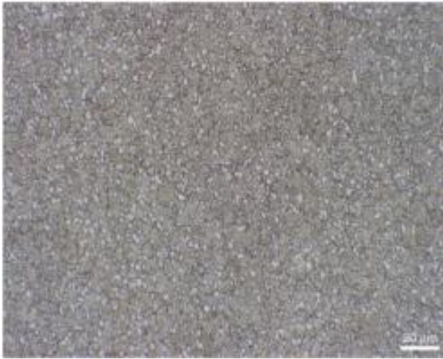
Obr. 11. Nástrojová oceľ vyrobená metódou PM - VANADIS 23.
