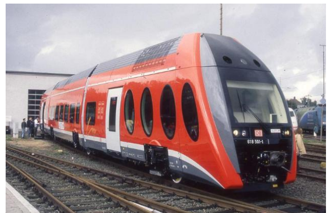
Obr. 5. Alstom Coradia Lirex poháňaná spaľovacím motorom [7]
