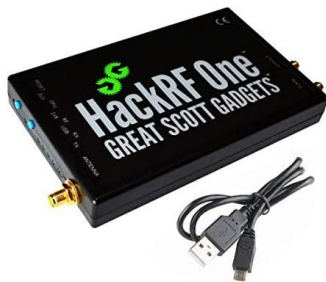
Obrázok 1: SDR prijímač HackRF One. Zdroj: https://images-na.ssl-images-amazon.com/images/I/41227i18ukL_AC_.jpg
