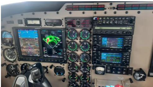
Obrázok 2. Zobrazenie motorových prístrojov Piper Seneca V
