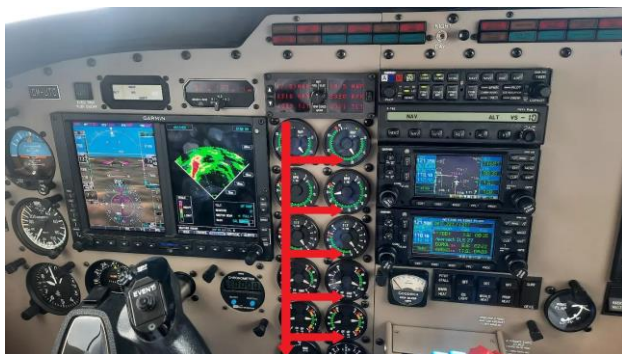
Obrázok 6. Návrh skenovacieho obrazca pre Piepr Seneca V
