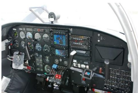
Obrázok 3. Zobrazenie motorových prístrojov Piper Seneca III
