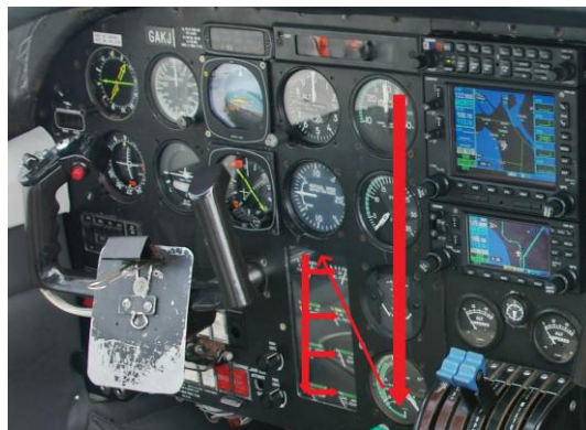
Obrázok 7. Návrh skenovacieho obrazca pre Piper Seneca III
