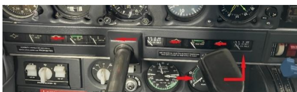
Obrázok 5. Návrh skenovacieho obrazca pre Piper Arrow
