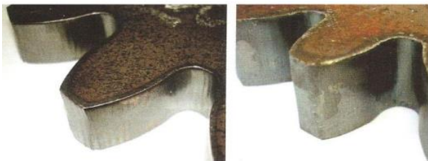
Obr. 3. Časť ozubenia vyrobená plazmovým lúčom pri rôznej hrúbke ozubenia
