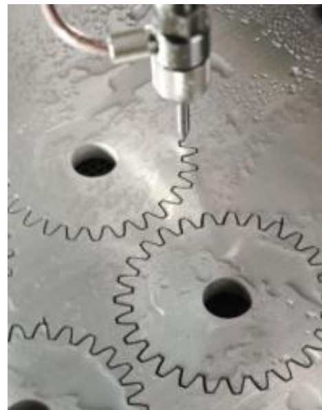
Obr. 2. Príklad použitia výroby ozubenia vodným lúčom
