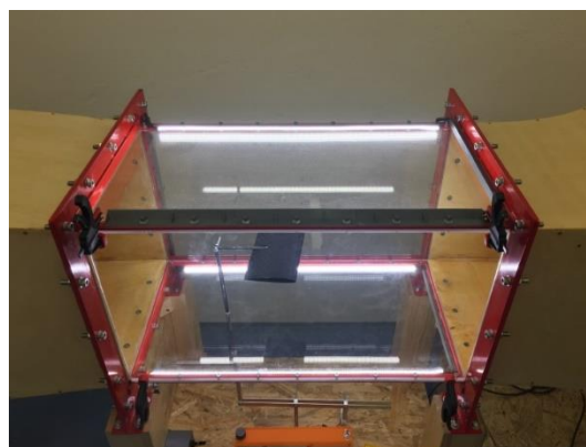
Obrázok 15: Pohľad na testovaciu sekciu s uchyteným testovacím profilom [zdroj: autor]
