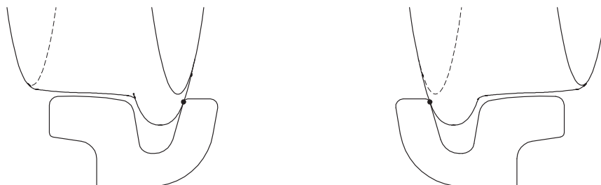
Obr. 5 Nep rijateln e postaven ı dvojkol ı v koleji za mez ı vzpr ıčení dvojkol ı ve voln m j zdn m kan lu (kolejnice typu NT1 R10 , rozchod koleje 1435 mm,  hel n b ehu dvojkol ı 5,16 , rozkol ı 1380 mm, j zdn ı obrys DPMB-004)
