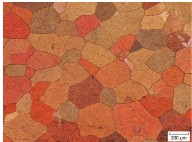
Obr. 8. Mikroštruktúra polotovaru pred pretlačovaním
