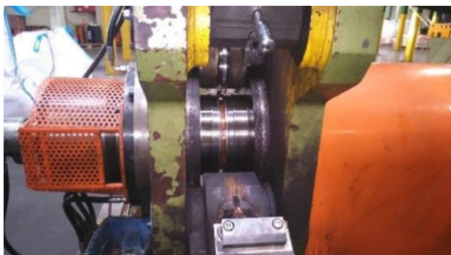
Obr. 4. Pohľad na otvorenú výstupnú časť pretlačovacieho zariadenia s odklopeným špeciálnym nástrojom (pretlačovacou hlavou)
