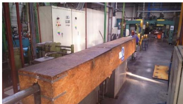
Obr. 6. Chladenie drôtu po pretlačovaní
