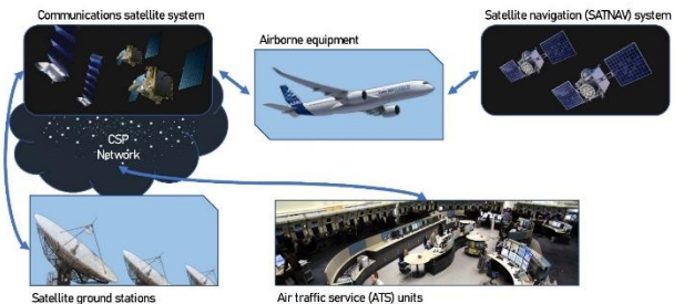
Obrázok 3: Prehľad dátového spojenia lietadlo-zem s použitím navrhovaného dátového spojenia LEO IP SATCOM. Zdroj: Autori
