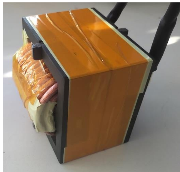
Obr. 6. Prototyp akumulčnej tlmivky pre navrhovaný menič
