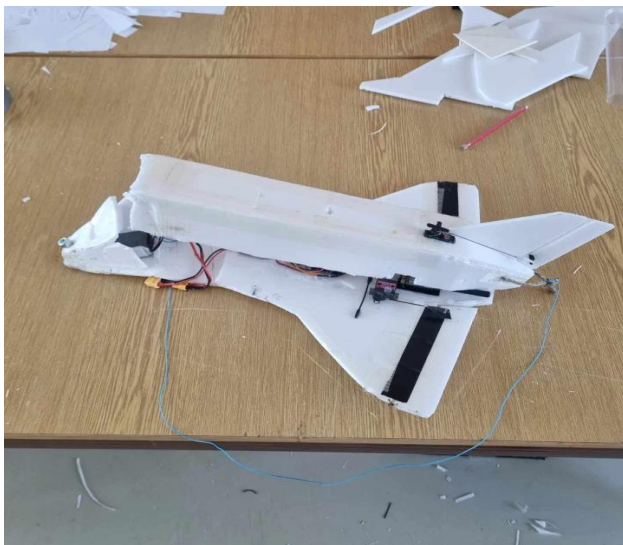
Obrázok 5: Zmenšený model klzáku po havárii
