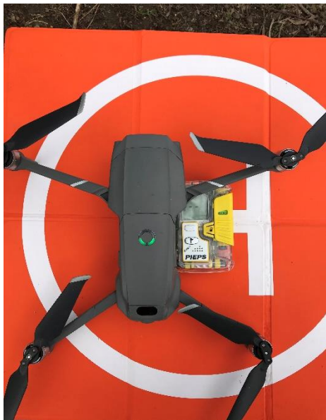
Obrázok 4: Strata prijímaného signálu po priložení DJI Mavic 2 PRO do tesnej blízkosti vyhľadávača. Zdroj: [19].
