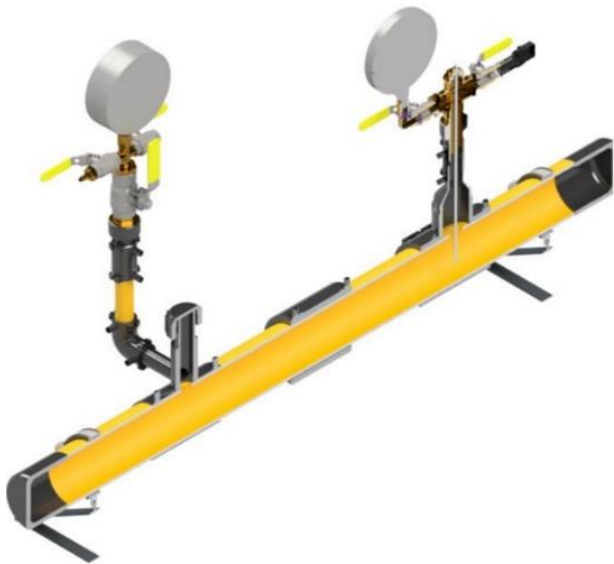
Obr. 4. Schéma experimentálnej zostavy pre výkon kombinovanej skúšky
