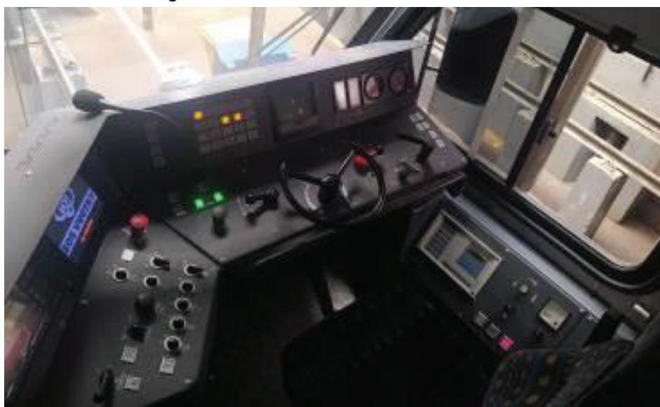
Obr. 6 Pult rušňovodiča na modernizovanej TEŽ 425.95
