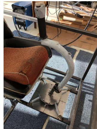
Obrázok 3: Pohyblivý mechanizmus riadiacej páky. Zdroj: Autori.
