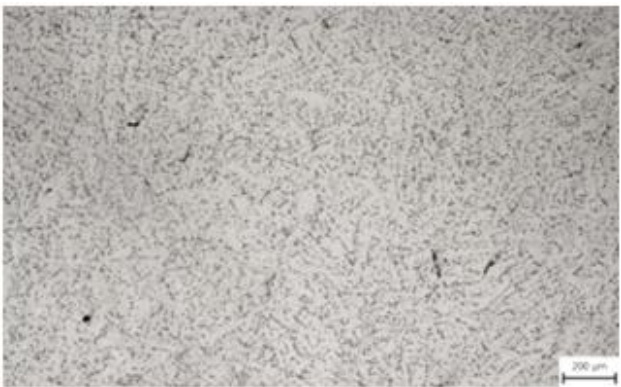
Obr. 6. Mikroštruktúra zliatiny AlSi_5Cu_2Mg po tepelnom spracovaní, leptané 0,5% HF
