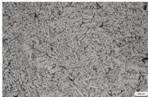
Obr. 4. Mikroštruktúra zliatiny AlSi5Cu2Mg pri teplote kovovej formy 370°C, leptaná 0,5% HF
