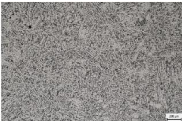
Obr. 5. Mikroštruktúra zliatiny AlSi_5Cu_2Mg pri teplote kovovej formy 250^{\circ}C , leptané 0,5% HF
