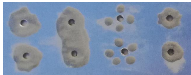
Obrázok 5: Hliníkový prášok nalepený na povrch plechu. Zdroj: Autori.
