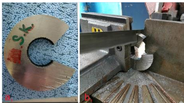
Obr. 2 (a) Polotovar; (b) delenie polotovaru na pásovej píle [5]
