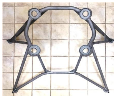
Obrázok 2: Konštrukcia lietadla „MX aircraft kit“ [Zdroj: https://www.mxaircraft.com/mx-aircraft-kits ]
