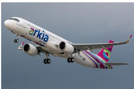
Obrázok 3: Airbus A321 NEO LR Izraelskej spoločnosti Arkia poháňaný motormi CFM Leap 1A a zakončením krídla typom "Sharklets" [31]
