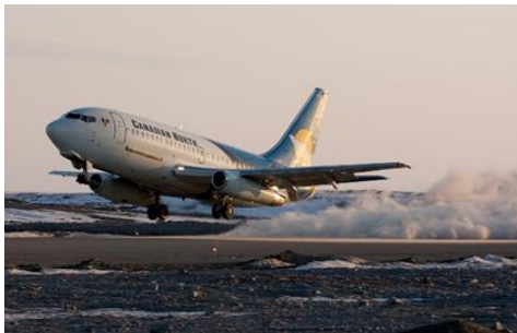
Obrázok 4: Boeing 737-200 spoločnosti Canadian North vo výbave "Gravel kit" a "Combi" vzlietajúci z nespevnenej vzletovo-prístávacej dráhy [32]
