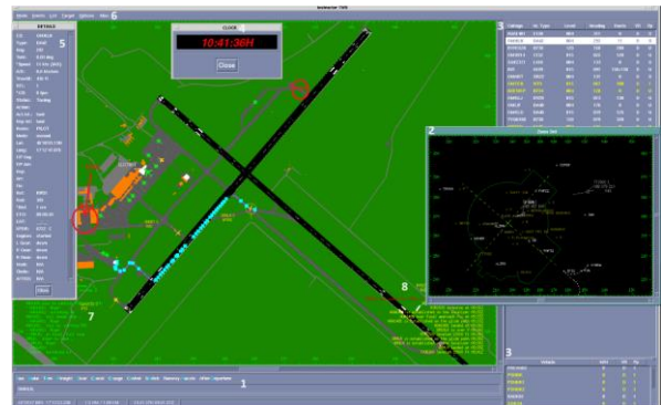
Obrázok 1. Užívateľské prostredie vežového simulátora s opisom jednotlivých ovládacích elementov a značením bodov špecificky používaných pri simulácii cvičení v prostredí Štefánik veža [Zdroj: LPS SR, š.p.]
