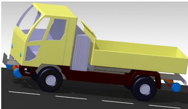
Obr. 15. Vozidlo Multicar M31 s koľajovými adaptérmi pri jazde po ceste
