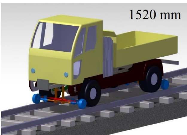
Obr. 7. Vozidlo Multicar M31 s navrhnutým podvozkom na trati s rozchodom 1520 mm
