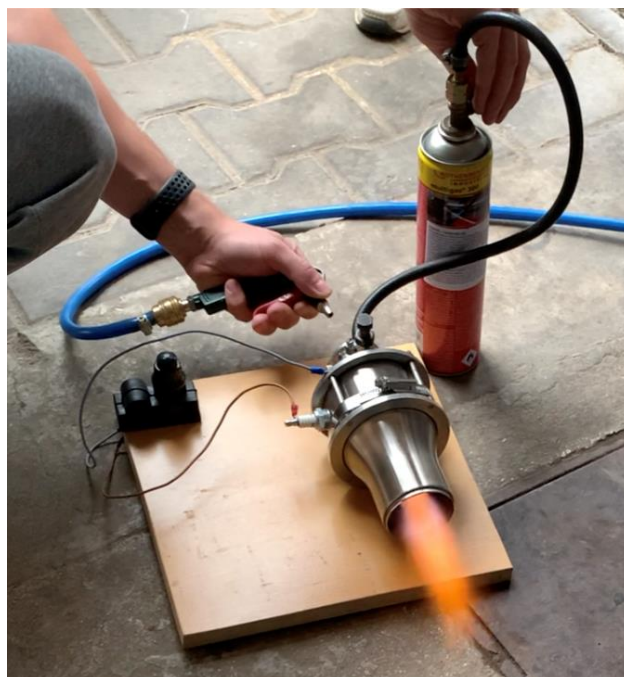
Obrázok 44: Testovanie spúšťacej sústavy [Zdroj: autor]
