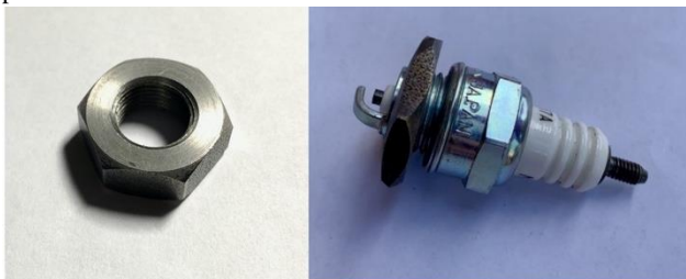
Obrázok 39: Pôvodná a upravená matica pre uchytenie zapaľovacej sviečky [Zdroj: autor]
