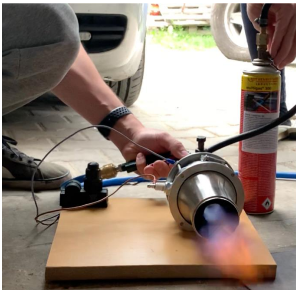
Obrázok 43: Testovanie spúšťacej sústavy [Zdroj: autor]
