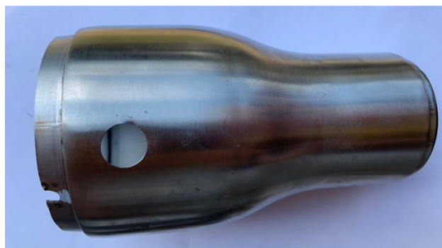
Obrázok 40: Plášť motora s vyvrtaným otvorom pre zapaľovaciu sviečku [Zdroj: autor]
