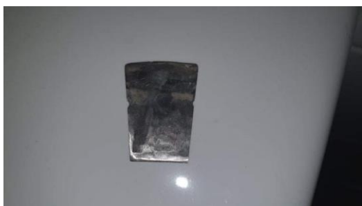
Obrázok 4: vzhľad testovaného materiálu bez TBC
