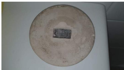
Obrázok 2: vzhľad vzoriek v epoxidovej živici s TBC
