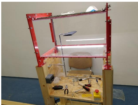
Obrázok 3: Systém merania aerodynamických síl (zdroj: Patrik Veľký)
