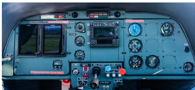
Obrázok 47: Navigačný systém Garmin G500 TXi zabudovaný v prístrojovej doske
