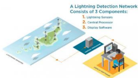
Obrázok 1: Zobrazenie komponentov detekčnej siete bleskov (senzory bleskov, centrálny procesor, systém zobrazenia) [11]
