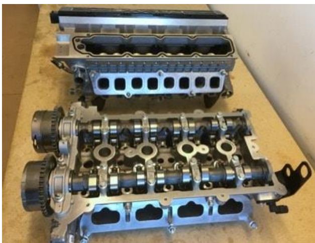
Obrázok 11: Porovnanie klasickej hlavy DOHC (vpredu) s hlavou valcov s technológiou FreeValve (vzadu) [7]
