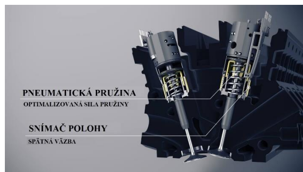
Obrázok 13: Vizualizácia ventilu, pružiny a aktuátora [4]
