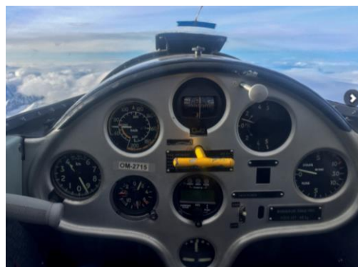
Obrázok 3 - Prístroje vetrona Blaník L-13 [Zdroj: http://www.aeroklubpoprad.sk/node/445 ]
