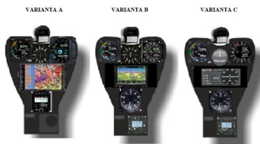
Obrázok 7: Varianty návrhu prerábky prístrojového vybavenia vetroňa VSO-10 [Zdroj:autor]
