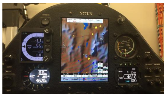
Obrázok 4: Prístrojová doska vetrona ASW - 27 [Zdroj: https://www.youtube.com/watch?v=bBjyEmdb0MA&t=128s ]
