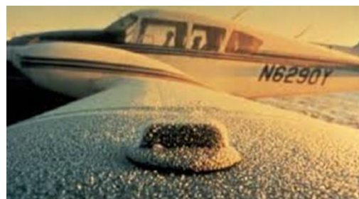
Obrázok 2: Kryštalická námrazu [Zdroj: https://www.vutbr.cz/www_base/zav_prace_soubor_verejne.php?file_id=65311 ]
