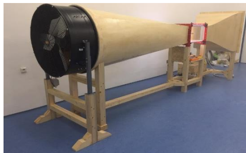
Obrázok 60: Zhotovený veterný tunel (zdroj: autor)
