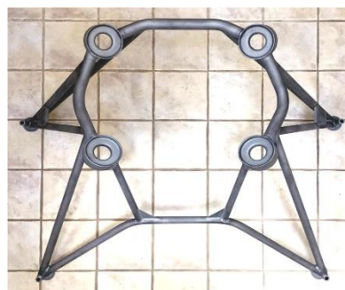
Obrázok 2: Konštrukcia lietadla „MX aircraft kit“ [Zdroj: https://www.mxaircraft.com/mx-aircraft-kits ]
