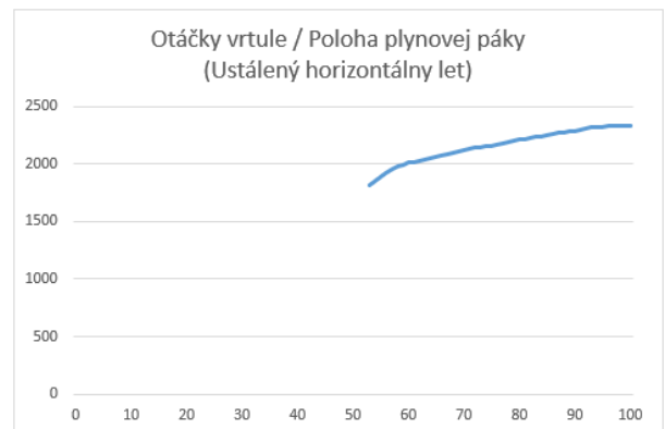
Obrázok 4: Graf rozmedzia výkonu v ustálenom horizontálnom lete. Zdroj: Vlastné meranie.
