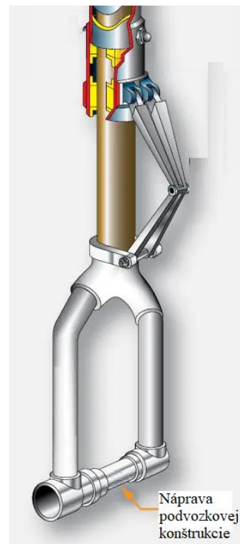
Obrázok 14: Náprava podvozovej konštrukcie. Zdroj: [https://www.aircraftsystemstech.com/p/landing-gear-support.html].
