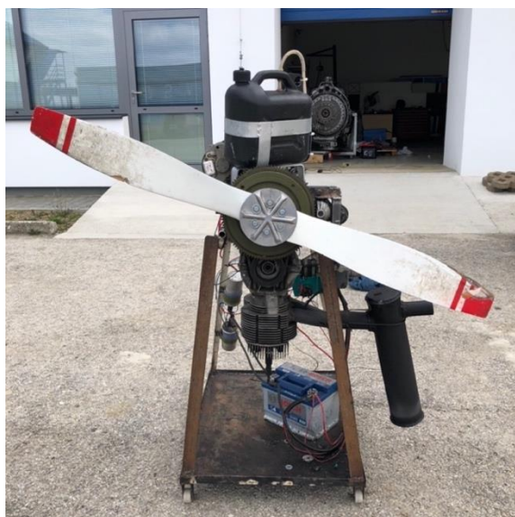
Obrázek 3: Přestavěný letecký motor. Zdroj: Autori.
