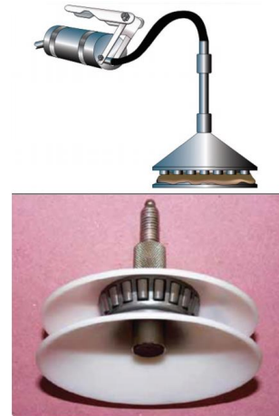
Obrázok 3: Nástroj pre tlakové mazanie ložiska. Zdroj: [6].
