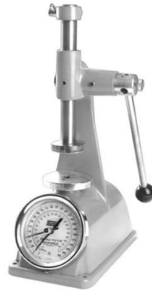
Obrázok 15: Zariadenie na skúšku stlačenia pružiny. Zdroj: [6].
