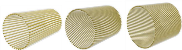
Obrázek 12: Variace supravodivých elementů v elektromagnetickém válci. Zdroj: Autori.
