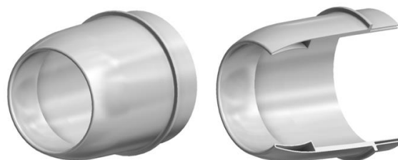
Obrázek 4: Schématické zobrazení vstupního ústrojí: v plném zobrazení (vlevo), v průřezu (vpravo). Zdroj: Autori.
