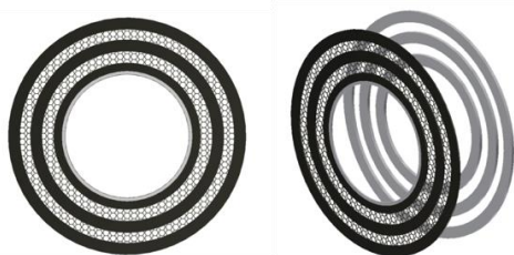
Obrázek 15: Schematické zobrazení mřížky společně s izolantem .Zdroj: Autori.
