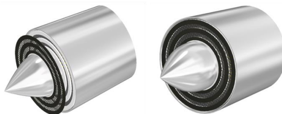
Obrázek 16: Schematické zobrazení umístění mřížky s izolantem na vstupu do kompresoru. Zdroj: Autori.
