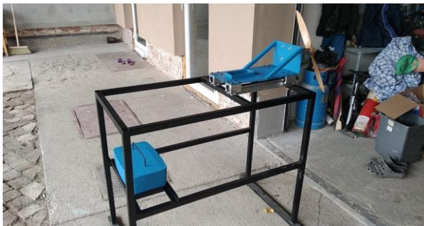
Obrázok 13: Hotová stojanová konštrukcia, nosná časť meracej platformy, prídavné závažie, lineárne vedenie a na skúšku osadený spaľovací motor. Zdroj: Autori.
