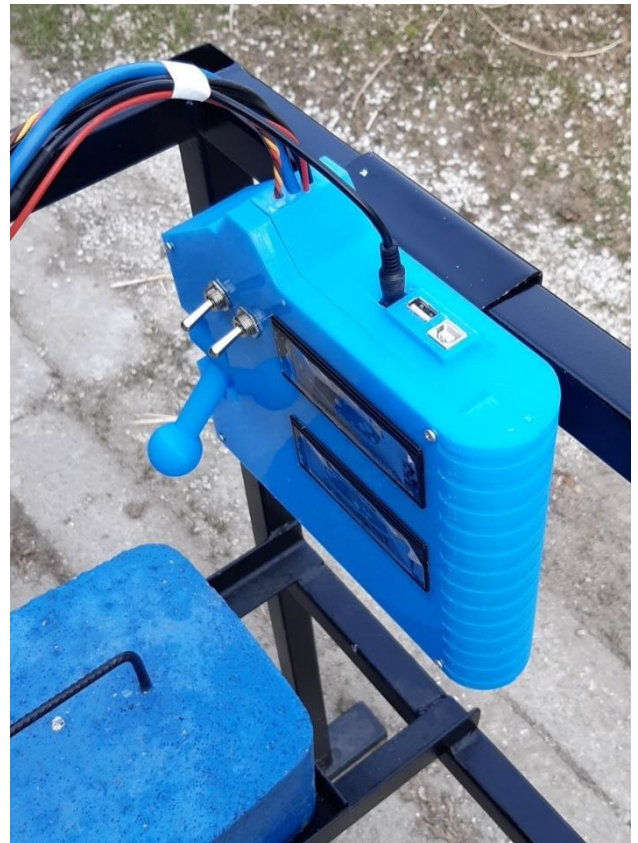
Obrázok 15: Kompletne postavený a na 3D tlačiarňi vytlačený ovládač meracieho zariadenia s dvoma displejmi, riadiacou jednotkou, potrebnou kabelážou, ovládacou pákou plynu motora a dvojice vypínačov. Zdroj: Autori.
