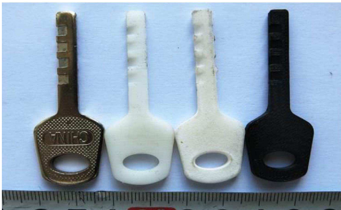
Obrázok 6 Porovnanie kvality 3D modelov kľúča vytvorených 3D tlačiarňou (Wang, 2020)
