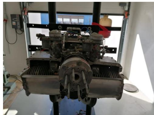
Obrázok 12: Motor M60 s riadiacou jednotkou a založeným krytom kľukového hriadeľa. [Zdroj: autori]
