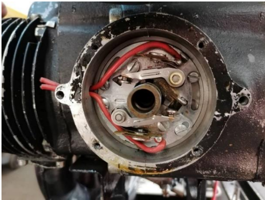
Obrázok 1: Druhá dvojica prerušovacích kontaktov motora M60. [Zdroj: autori]
